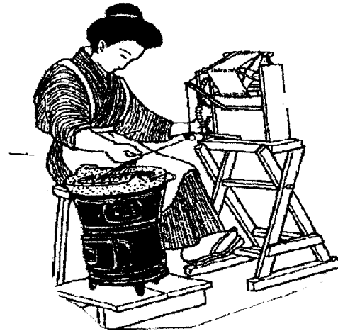
▲座繰り（ざぐり） 繭を煮ながら糸を取り出し、糸枠に巻 きつける。
