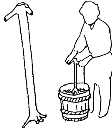
▲芋洗い棒（いもあらいぼう） 芋類と水を桶に入れ、芋洗い棒で掻き混ぜて芋の泥を落とす。一ヶ所から何本も枝が出た自然の股木（またぎ）を使用。
