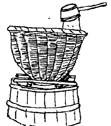
▲塩作り用のざる 海水を砂浜にかけて塩分を強くし、その砂をざるに入れ、そこに海水を注ぐと高濃度の塩水ができる。この水を煮詰めて塩を作る。
